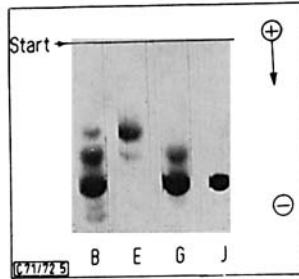
Abbild. 5. Polyacrylamidgel-Elektrophorese von synthetischem Sekretin I; Gelsystem nach Reisfeld , pH 4.5, 10proz. Trenngel; Amidoschwarz-Färbung
